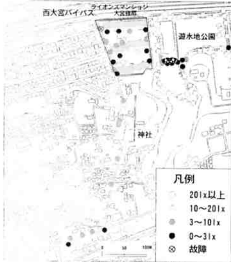
図1 街灯下の水平面照度
