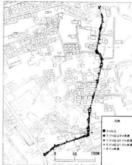
図3 5m間隔の鉛直面照度
