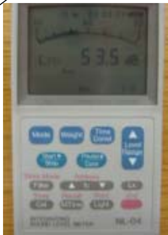
このような騒音計を使って実測します。
